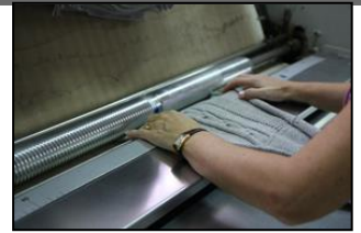
Entry position of the knitting blank Posición de entrada del trozo menguado
