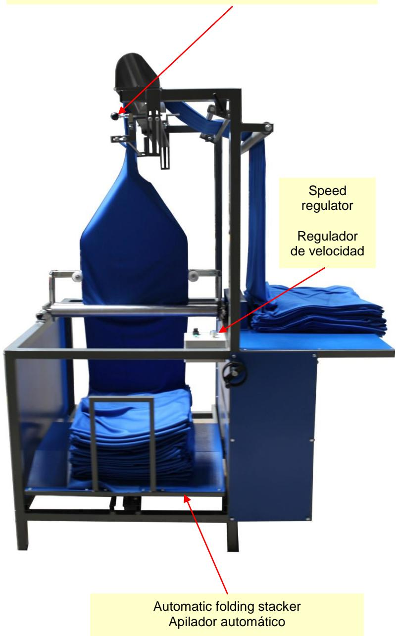
La máquina para Cuarto de Giro Tubular ha sido diseñada para aquellas empresas que quieran esconder el pliegue del tubular. Este sistema es mucho más eficiente que el sistema tradicional de giro del tubular acoplado a la máquina de extender:
